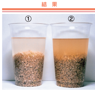
水道水の方①は少し濁った程度だが…マイナスイオン調整液を入れた方②はご覧の通り黄色と言うより焦げ茶色に近く濁った。
